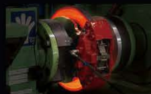
フル制動時の状態を再現するダイナモテスト。ローターが800℃以上にも達する中で、スリットの効果など多項目を検証。
