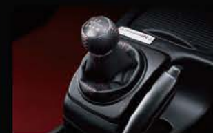
シビック TYPE Rのφ47mmからφ50mmに径を上げ、しかも革巻とすることで、グリップ感を向上させた専用シフトノブ。
