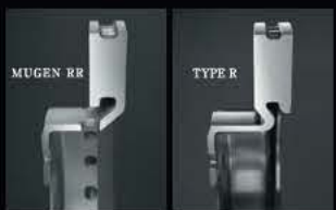
外側の摺動面とハットの間の隙間から走行風をローター内に取り入れ、高い冷却効果をもたらす逆ベンチ形状。
