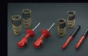
一段と強化されたスプリングと、フロントは減衰力を高め、リアはしなやかな特性としたダンパーから成る専用サスペンション。
