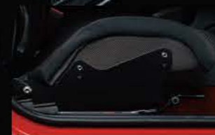
ノーマルポジションとサーキットポジション。取付ボルト位置の変更でシート高が変えられる上下2段階調整機構を採用。
