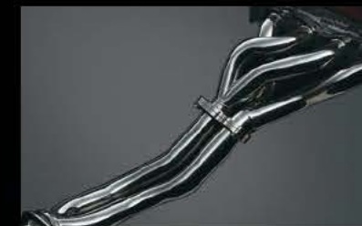
集合ポイントの変更で集合部をより先鋭化し、等長化も行ったステンレス製4-2-1エキゾーストマニホールド。排気干渉を低減し、中回転域トルク向上にも寄与。
