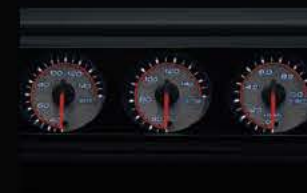
水温、油温、油圧。過酷なサーキットでの走行で不可欠なインフォメーションを視認性高く伝える3連アシストメーター。
