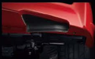
バンパー一体のダクトで風を高効率に導入。冷却効果を高め、優れた耐フェード性をもたらす、安定した制動性能を実現。
