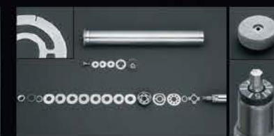
フロントダンパーはスリットバルブのスリットを3本から1本にすることで減衰力をアップ。またリアともに、専用工具でツマミを回すことで減衰力を幅広く5段階に調整が可能。
