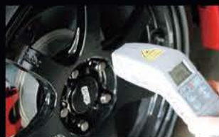
サーキットで過酷な実走を行った直後に制動装置付近を検温。こうした実地測定での記録にも基づき、冷却対策を徹底。
